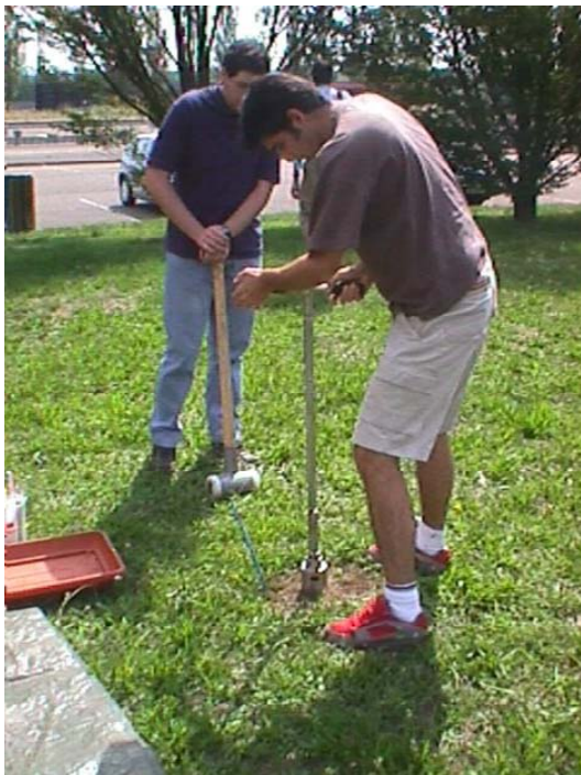
(c) Carottage à la tarière manuelle
