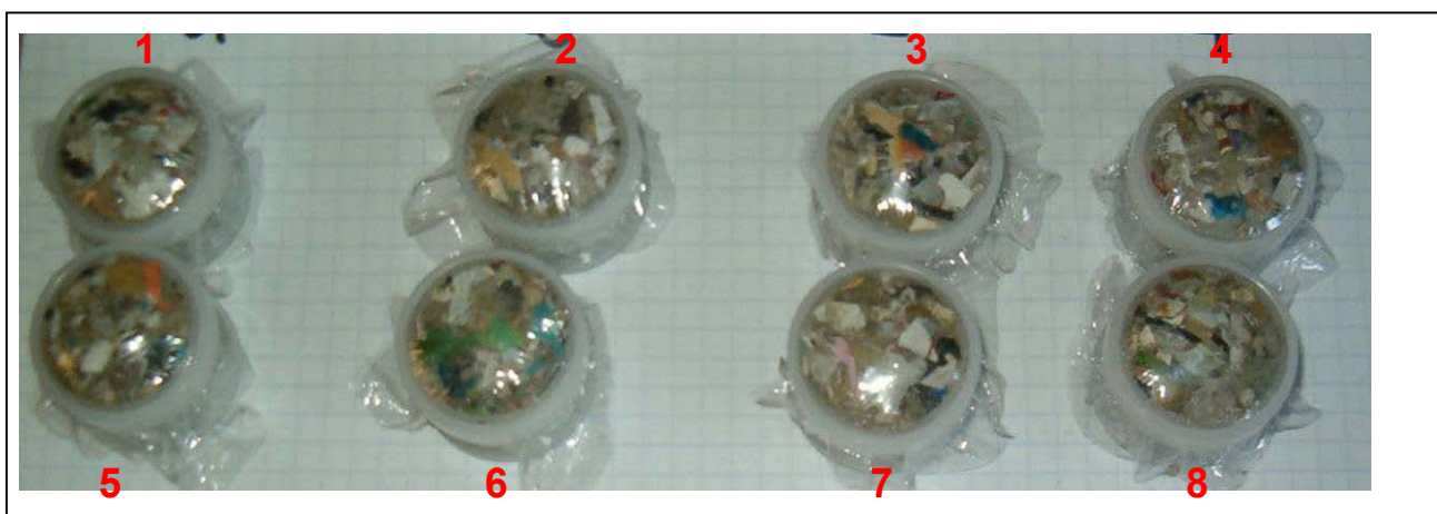
PHOTOGRAPHIE 25 : COUPELLES REALISEES A PARTIR DE 150G DE REFUS DE TRI DE GRANULOMETRIE REDUITE DESTINEES A ETRE ANALYSEES AVEC LES APPAREILS XRF
