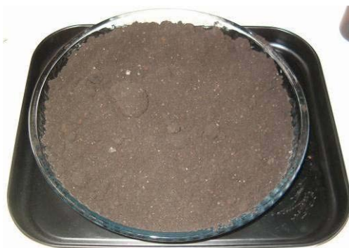
PHOTOGRAPHIE 32 : BOUE D'ACIERIE ETALEE DANS UN PLAT POUR ANALYSE AVEC L'APPAREIL XRF DE TYPE PISTOLET « ON SITE »
