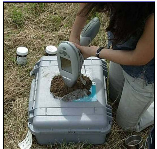
Homogénéisation de l'échantillon et mesure « on site ».
