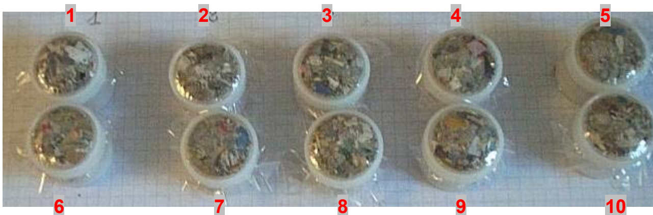
PHOTOGRAPHIE 30 : COUPELLES REMPLIES DE REFUS DE TRI SEC, ET DESTINEES A UNE ANALYSE EN MODE LABORATOIRE AVEC LES APPAREILS XRF
