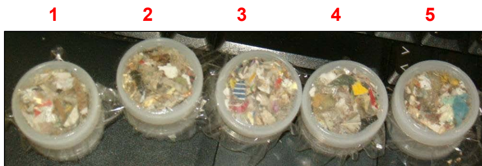
PHOTOGRAPHIE 24 : ECHANTILLON DE 50 G DE REFUS DE TRI DE GRANULOMETRIE REDUITE ET COUPELLES REALISEES A PARTIR DE CET ECHANTILLON DESTINEES A ETRE ANALYSEES AVEC LES APPAREILS XRF
