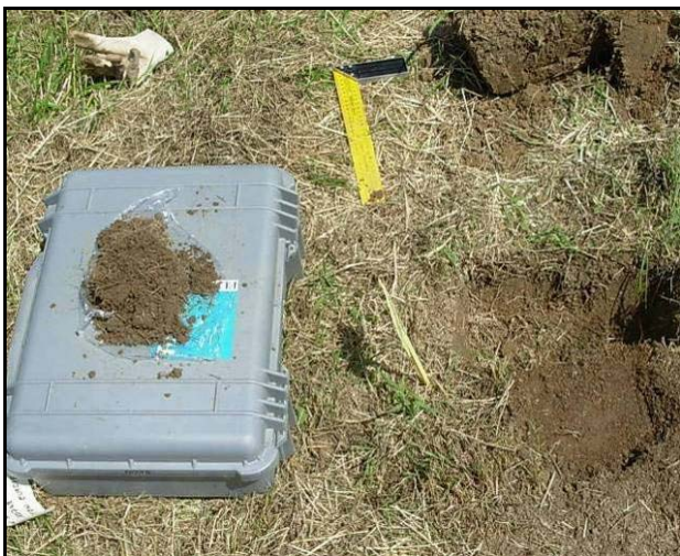
Prélèvement d'une couche de 1 cm d'épaisseur
