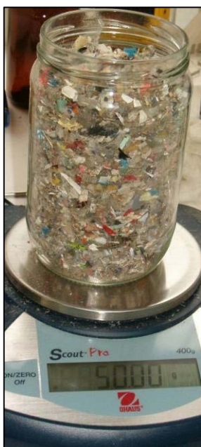
PHOTOGRAPHIE 24 : ECHANTILLON DE 50 G DE REFUS DE TRI DE GRANULOMETRIE REDUITE ET COUPELLES REALISEES A PARTIR DE CET ECHANTILLON DESTINEES A ETRE ANALYSEES AVEC LES APPAREILS XRF
