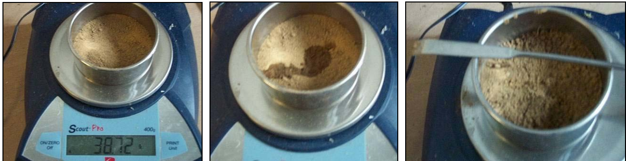
PHOTOGRAPHIE 15 : LES ETAPES DU DOPAGE EN EAU : PESEE DE L'ECHANTILLON, AJOUT DE LA QUANTITE D'EAU NECESSAIRE, HOMOGENEISATION
