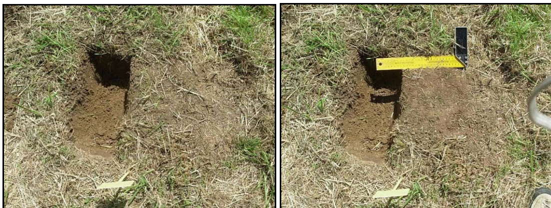
PHOTOGRAPHIE 10 : PREPARATION D'UNE SURFACE DE 20X20 CM POUR LA REALISATION D'ANALYSES XRF « SATISFAISANTES » ET CREUSEMENT D'UN FOSSE
