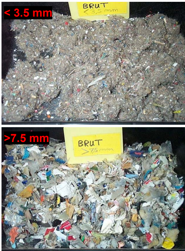
PHOTOGRAPHIE 21 : APERÇU DES 3 FRACTIONS GRANULOMETRIQUES DE L'ECHANTILLON REFUS DE TRI BRUT
