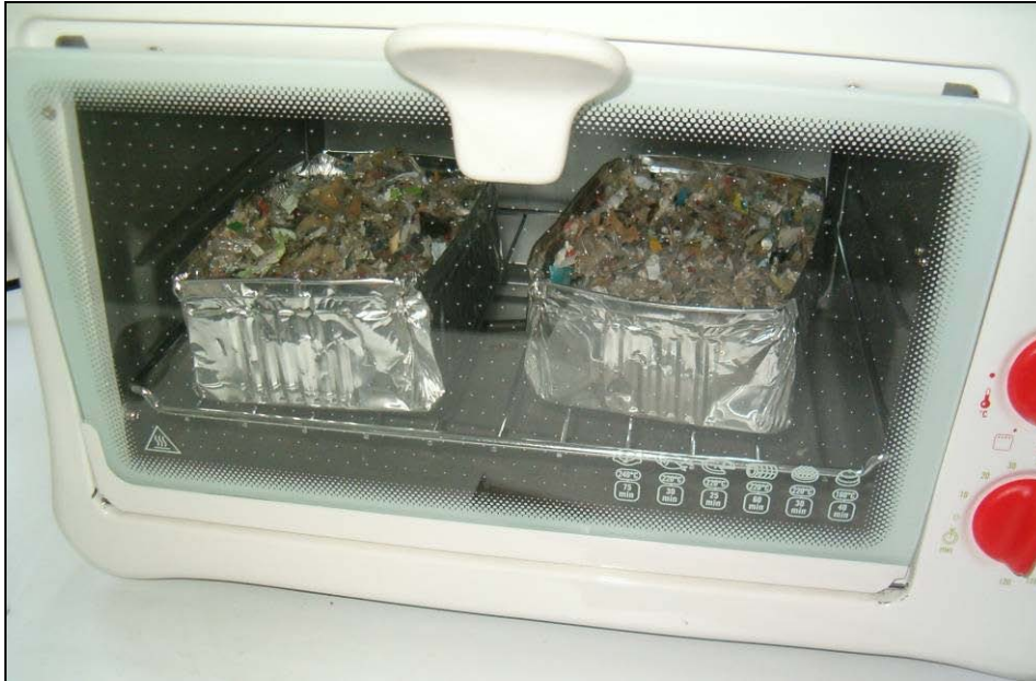
PHOTOGRAPHIE 29 : SECHAGE AU FOUR ENTROUVERT A 65°C DE 100G DE REFUS DE TRI CONTENANT 25% D'EAU
