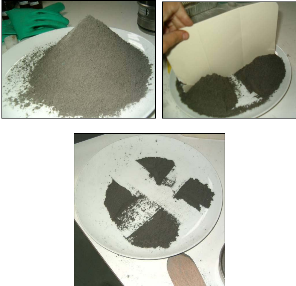
PHOTOGRAPHIE 33 : QUARTAGE DU PORTEUR D'ALUMINE AVEC LA METHODE DU CONE
