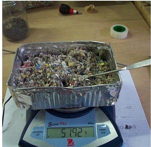
PHOTOGRAPHIE 27 : DOPAGE DE REFUS DE TRI DE GRANULOMETRIE REDUITE AVEC DE LA POUDRE DE PVC - A : POUDRE DE PVC ; B : ECHANTILLON DE REFUS DE TRI EN COURS DE DOPAGE AU PVC
