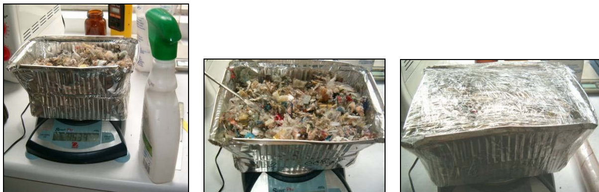
PHOTOGRAPHIE 28 : DOPAGE EN EAU DU REFUS DE TRI SEC : PESEE, PULVERISATION D'EAU ET MELANGE, 1 JOUR D'IMPREGNATION SOUS FILM ETIRABLE.
