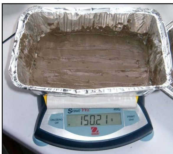
PHOTOGRAPHIE 5 : PESEE D'UN SEDIMENT FLUVIATILE BRUT AVANT SECHAGE
